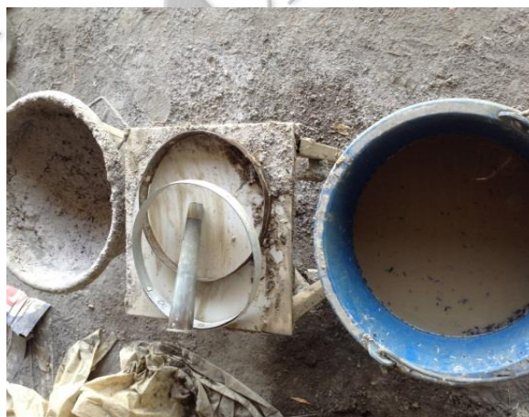
ภาพประกอบ 13 แม่พิมพ์วงกลมรังผึ้ง , แม่พิมพ์รูรังผึ้ง , ถัง , กระจก
