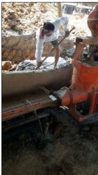
ภาพประกอบ 22 การตัดอิฐมอญใส่เครื่อง
